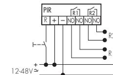
Über einen separaten Remote-Eingang (R) kann das Licht bei Bedarf manuell ein- bzw. ausgeschaltet werden.
